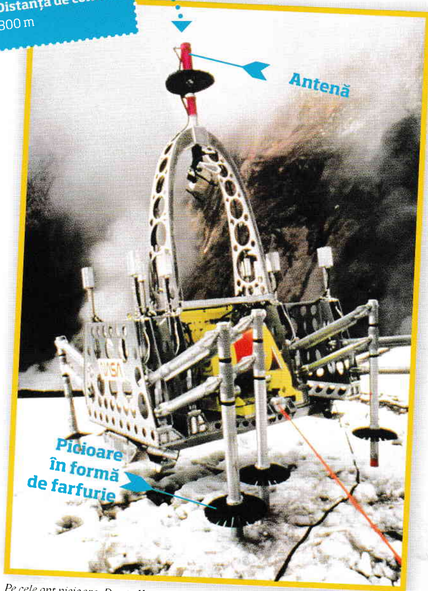
Pe cele opt picioare, Dante II coboară pe marginea craterului vulcanului, sigur ca un alpinist.
